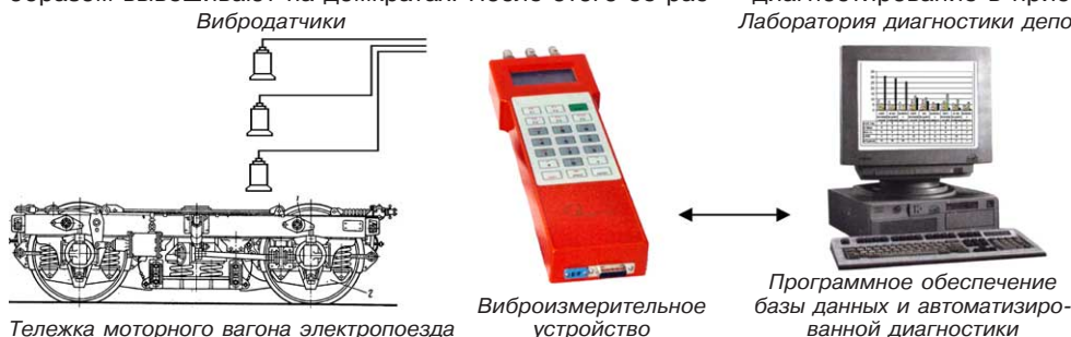
Рис. 1. Типовая структурная схема вибродиагностического комплекса, применяемого для диагностики КРБ электропоездов
